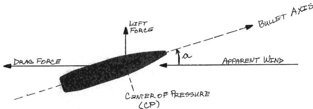
FIGURE 2. AERODYNAMIC FORCES ON BULLET IN FLIGHT
